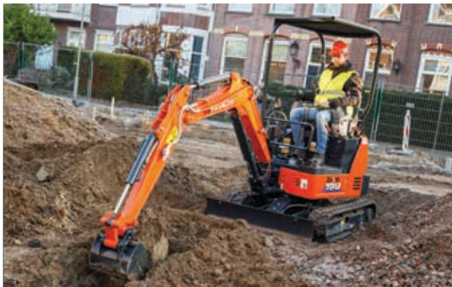
Der hydraulisch verstellbare Unterwagen ermöglicht je nach Einsatz beste Standsicherheit oder minimale Durchfahrtsbreite.
